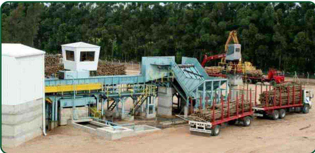
Uma linha de picagem moderna e compacta projetada para operar com toras curtas e longas que flexibiliza o fornecimento de madeira.
